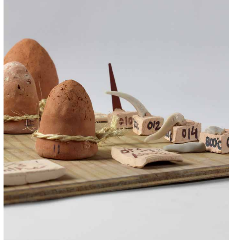
Recherches autour de la porosité grès additionné de matières organiques, cuit en basse température
